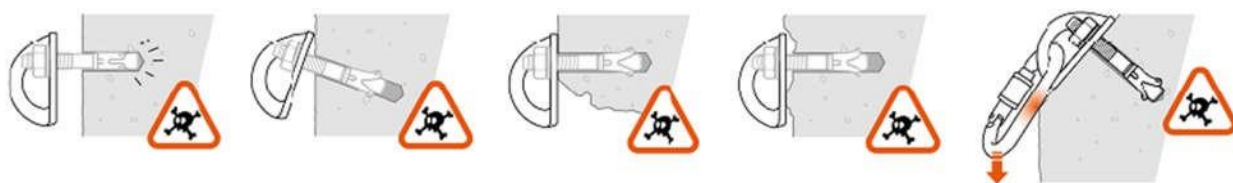
Παραδείγματα από εσφαλμένες τοποθετήσεις αγκυρίων
