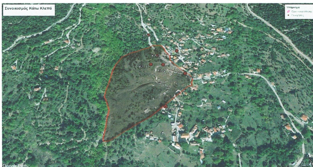
Εικόνα 3: Ενδεικτικά όρια της κατολίσθησης του 2015 που έπληξε τον συνοικισμό "Κάτω Κλεπά", όπως φαίνεται σε δορυφορική εικόνα του Google-Earth την 23/10/2019 με τις θέσεις γεωτεχνικών γεωτρήσεων που ανορύχθηκαν το 2015 στο πλαίσιο εκπόνησης των κάτωθι μελετών
