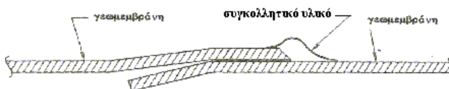
Εικόνα 2: Συγκόλληση με εναπόθεση υλικού
