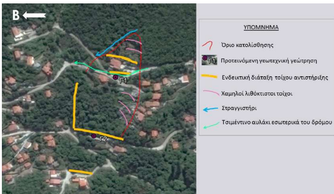
Εικόνα 12. Ενδεικτική διάταξη των προτεινόμενων παρεμβάσεων. Ο τελικός σχεδιασμός των έργων θα γίνει μετά την υλοποίηση της γεωτεχνικής μελέτης.
